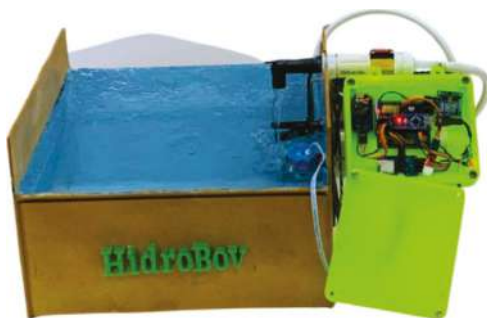
Figura 1 - Estrutura do HidroBov com os sensores interconectados
